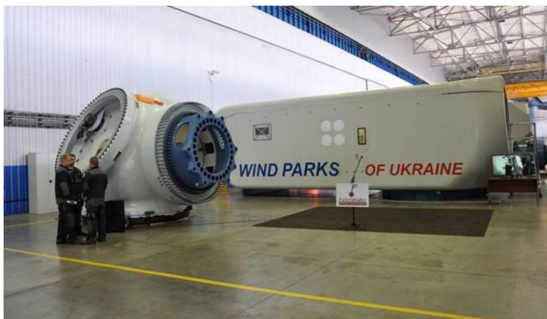
Виготовлені на Краматорському підприємстві «Фурлендер Віндтехнолоджі» частини першої в Україні ВЕУ потужністю 3,2 МВт.
